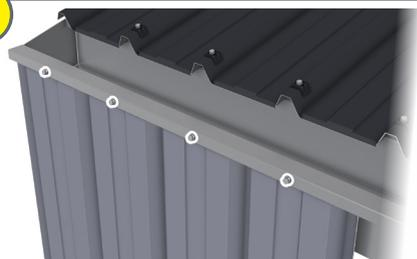
La parte superior de la hoja de revestimiento debe deslizarse en el retorno del canalón.
