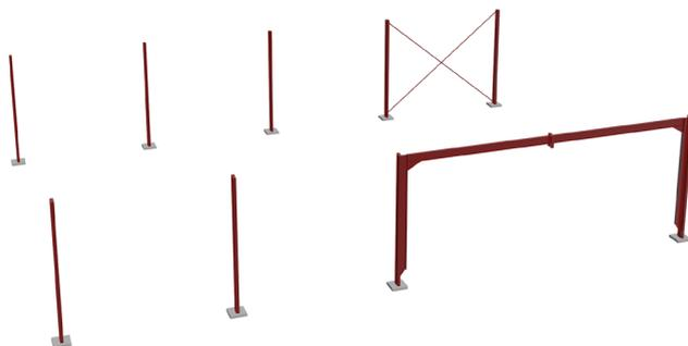
Si su edificio tiene una **viga de carga**, móntela de acuerdo con el plano recibido y atornille la viga utilizando **pernos 16 x 50**.
