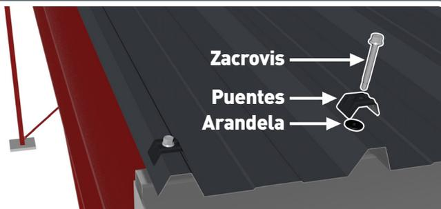
Fije la chapa con **Zacrovis 6.3 x 60**, los **puentes** y **arandelas neopreno**. Un tornillo por onda.
