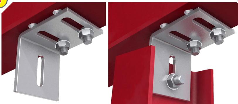
Atornille los **soportes de poste** a los travesaños del frontón utilizando **tornillos 12 x 30**.
