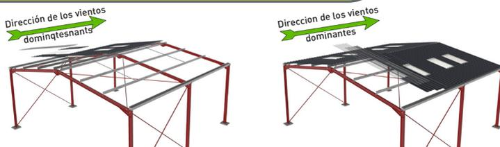
Coloque las planchas de acuerdo con los **vientos dominantes** para evitar que el agua suba a los recubrimientos.
