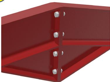
En el caso de una construcción a dos aguas, atornilla las **vigas** de 2 por 2 utilizando **pernos 16 x 50**.
