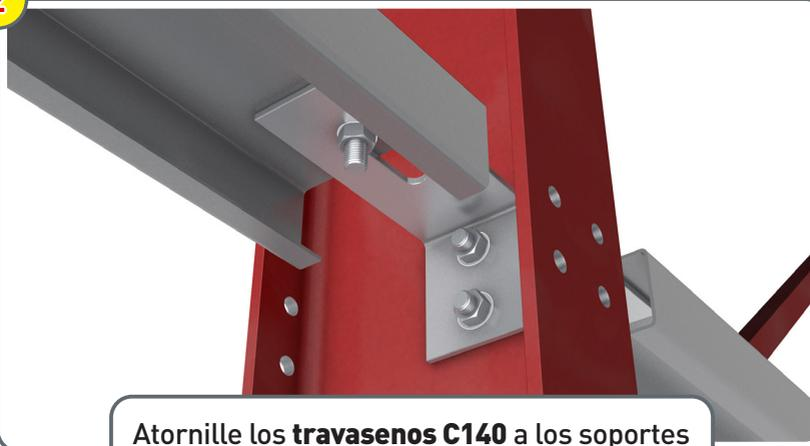
Atornille los **travaseños C140** a los soportes con **tornillos 12 x 30**.
