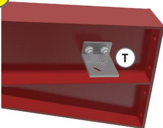
Montieren Sie die **kreuzförmigen Befestigungselemente T** mit **12 x 30 Bolzen S** gemäß dem Schema auf der vorherigen Seite.
