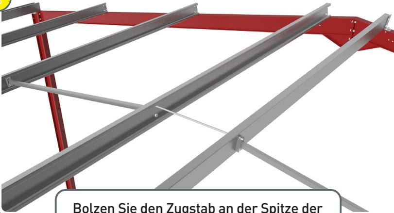
Bolzen Sie den Zugstab an der Spitze der beiden Firstpfetten.
