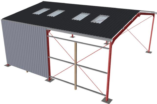
Und machen Sie weiter so und überprüfen Sie stets die Vertikalität der Bleche mit einer Wasserwaage.
