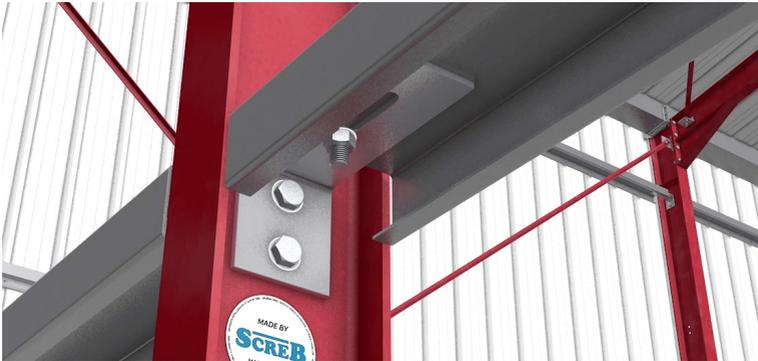
Verschrauben Sie die **Längsträger Profil C140** an den an den Stützen verschraubten Halterungen mit den **12 x 30 Bolzen**.
