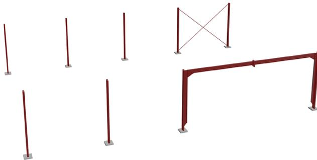
Falls Ihre Halle über einen **tragenden Träger**, verfügt, montieren Sie ihn ebenfalls gemäß dem erhaltenen Plan und verschrauben Sie den Träger mit den **16 x 50 bolzen**.
