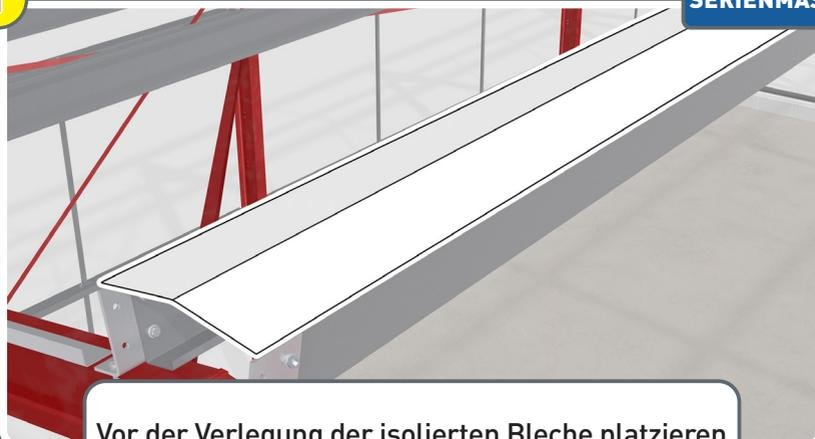
Vor der Verlegung der isolierten Bleche platzieren Sie die **Unterfirstbleche** auf den Firstpfetten.
