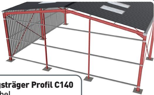
Montieren Sie alle **Längsträger Profil C140** am Giebel.
