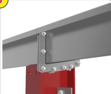
Befestigen Sie den Rinnenkanal mit den **10 x 30 Bolzen**.
