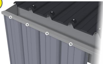
Der obere Teil des Wandverkleidungsblechs muss in die Rinneaufkantung geschoben werden. Befestigen Sie das Blech dort mit **4 Zacrovis-Schrauben 6.3 x 25**.
