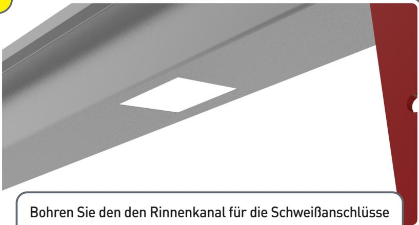
Bohren Sie den den Rinnenkanal für die Schweißanschlüsse und schweißen Sie ihn dann. Optional, wie unten gezeigt, können Sie auch **Schraubanschlüsse verwenden**.
