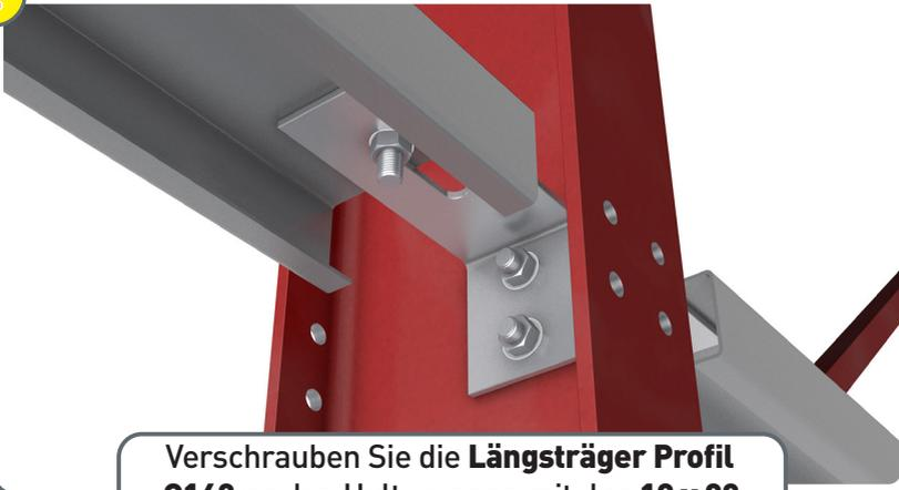
Verschrauben Sie die **Längsträger Profil C140** an den Halterungen mit den **12 x 30 Bolzen**.
